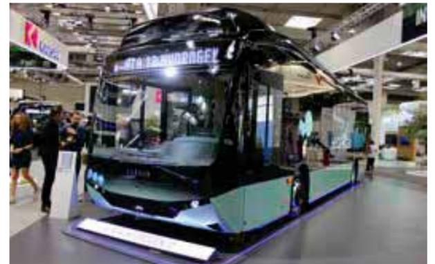
Der türkische Busbauer Karsan liefert mit dem e-ATA einen 12-Meter-Bus mit Brennstoffzelle und einer Reichweite von mehr als 500 Kilometer.
