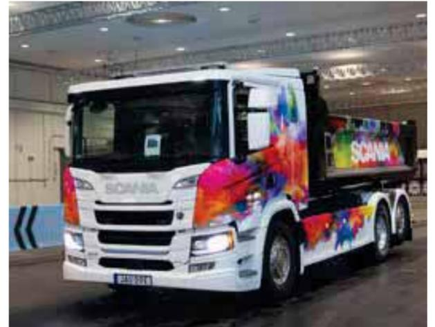
Der batterieelektrische Scania 25P ist die emissionsfreie Lösung für den mittelschweren Regional- und Stadtverkehr.
