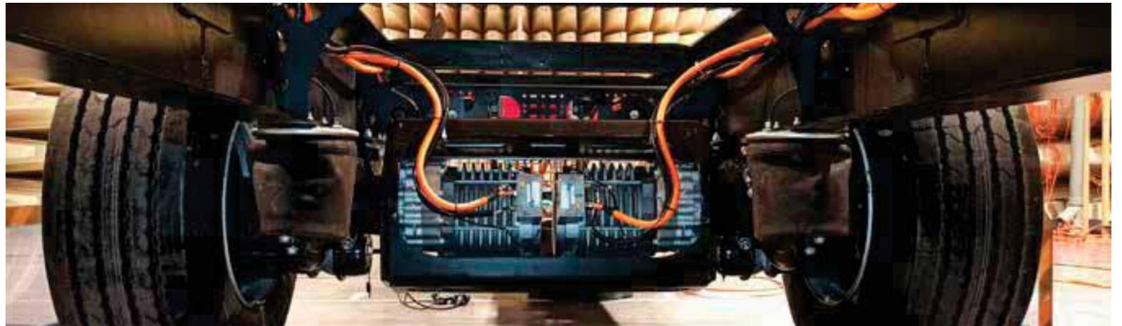
Die ePower ist mit zwei Generatoren mit einer maximalen Leistung von je 8 kW ausgestattet. Sie soll den Dieserverbrauch pro Jahr und Fahrzeug um bis zu 4.000 Liter reduzieren können.
