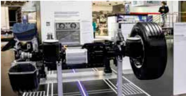
Schmitz Cargobull hat seine eigene Rekuperationsachse entwickelt. Sie versorgt eine elektrische Transportkältemaschine.
