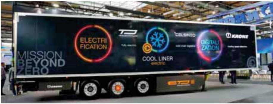
Elektrisierende Kooperation: Krone hat den eCool Liner in Zusammenarbeit mit dem Start-up Trailer Dynamics auf die Achsen gestellt. Die E-Achse in der Mitte des Trios unterstützt den Fahrtrieb der Zugmaschine und gewinnt Bremsenergie zurück. Die im Trailer mitgeführte Energie ist auch für Langstrecken von rund 500 Kilometer ausreichend.
