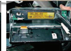
... bei genauer Kontrolle der Polizei steckt ein zusätzlicher analoger Tacho dahinter.
