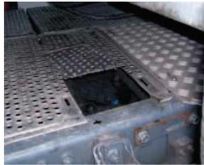
Die Klappe im Blech über dem Getriebe erleichtert die Magnetmanipulation.
