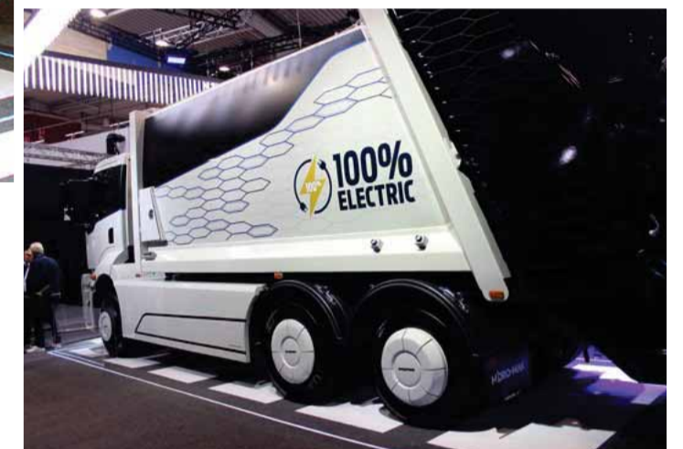
Der erste vollelektrische Ford Truck erinnert optisch an die Fernverkehrs-Baureihe F-Max. Der Dreiachser ist mit einem Müllsammelaufbau ausgestattet und soll es auf eine Reichweite von maximal 300 Kilometer bringen.
