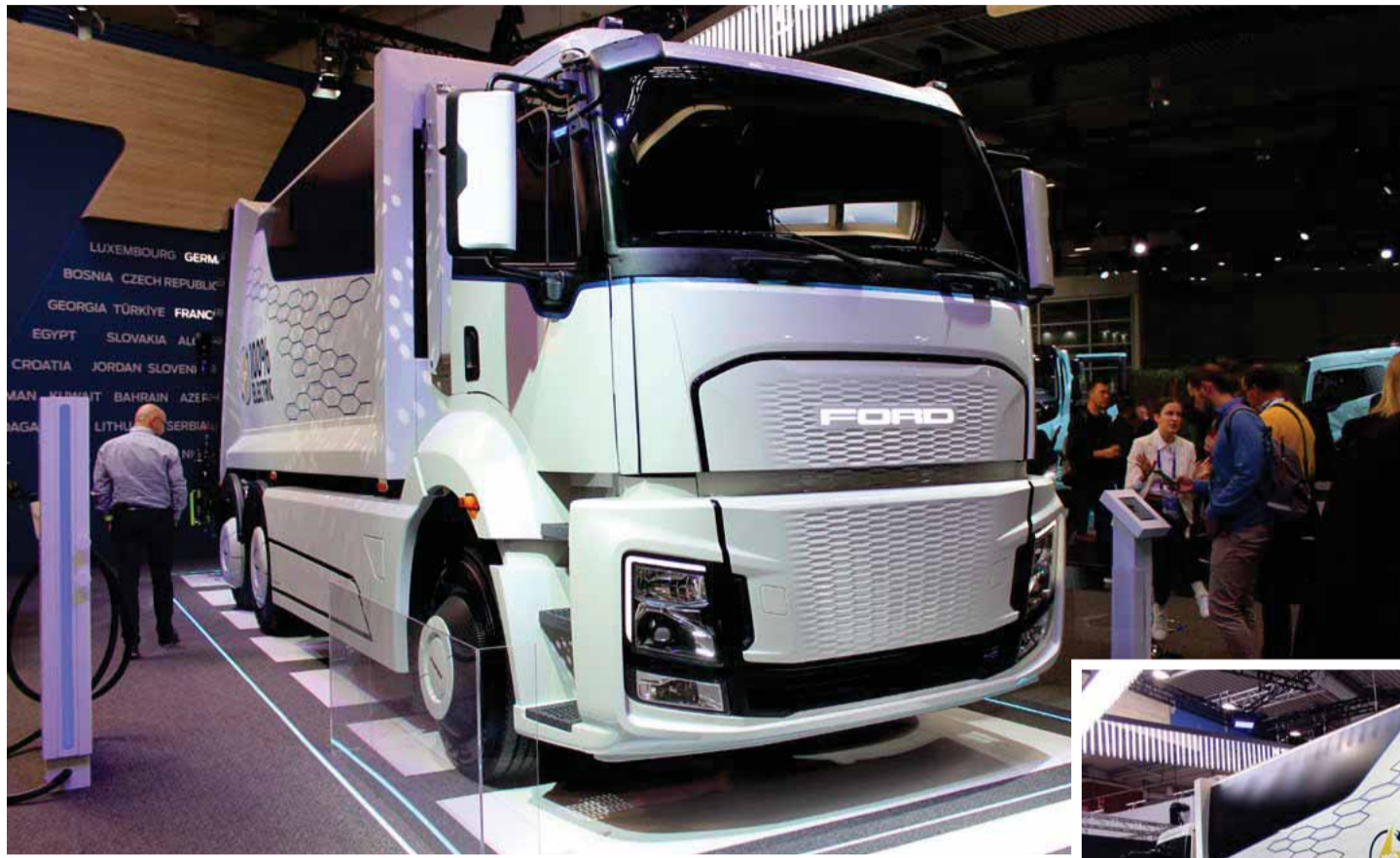
Der erste vollelektrische Ford Truck erinnert optisch an die Fernverkehrs-Baureihe F-Max. Der Dreiachser ist mit einem Müllsammelaufbau ausgestattet und soll es auf eine Reichweite von maximal 300 Kilometer bringen.
