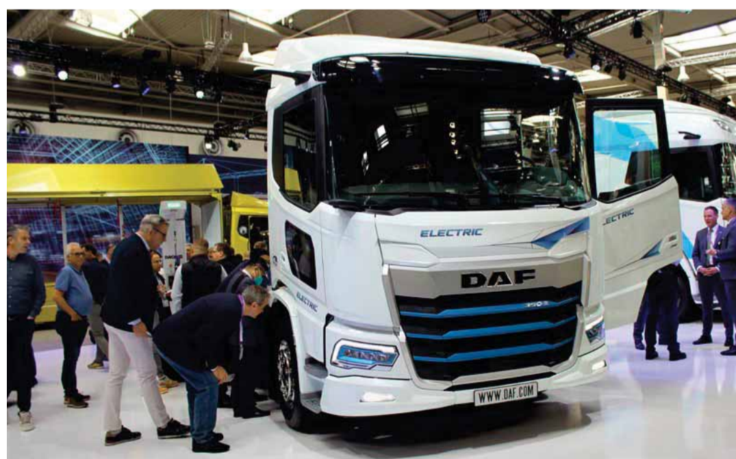
Die Electric-Version des DAF XD ist an blauen Kühlergrill-Lamellen und blau hinterlegten Scheinwerfern zu erkennen. In der Top-Version ist er 350 kW und 1.975 Nm stark.
