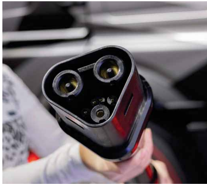
Neuer Stecker-Standard: Gerade für Nutzfahrzeuge mit kapazitätsstarken Batterien ist Megacharging wichtig, um in kurzer Zeit wieder Reichweite zu laden.
