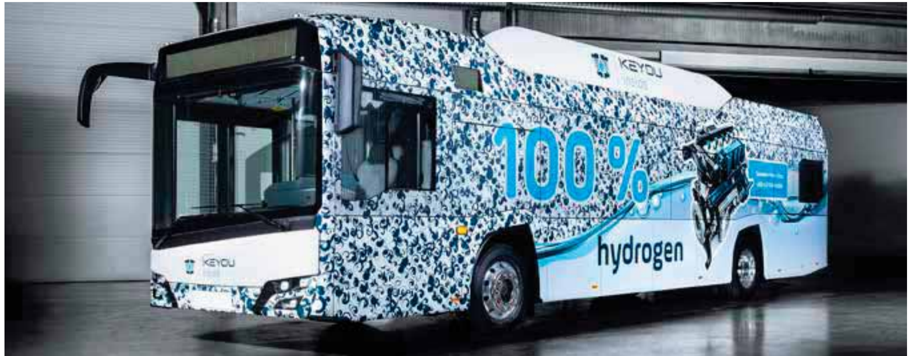
Der von Keyou präsentierte Stadtbus ist nicht nur mit einem Wasserstoffmotor ausgestattet, sondern auch mit einem Mild-Hybrid-System aus dem Hause Voith.
