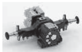
Die neue E-Achse soll dank integrierter Motor-Getriebe-Einheit Platz schaffen, der für zusätzliche Batterien und damit eine höhere Reichweite genutzt werden kann.
