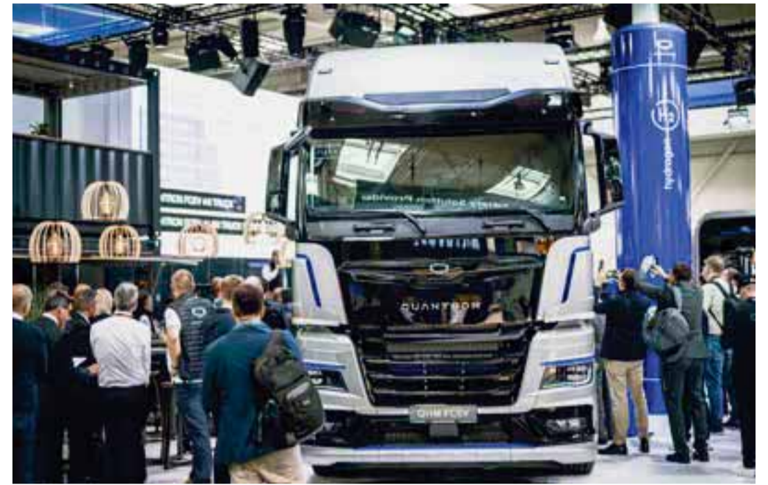
Der Brennstoffzellen-Truck QHM FCEV (oben) soll über eine Reichweite von 700 Kilometer verfügen. Mit Aero-Paket (rechts außen) verspricht Quantron zusätzlich zehn Prozent. So oder so finden die Wasserstofftanks (Schema rechts) am Rahmen Platz.
