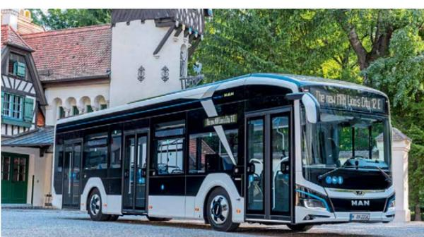
Sechs Batteriepacks auf dem Dach speichern die Energie für den Fahrtrieb des MAN Lion's City E.
