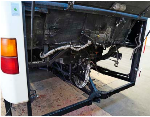
Der Motorraum des Mercedes Citaro der ersten Generation wird entkernt und mit elektrischen Bauteilen bestückt – die Batterien wandern jedoch immer aufs Dach.
