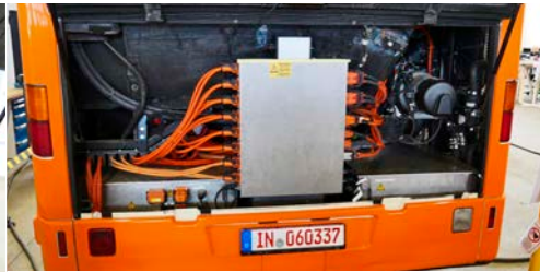
Der Motorraum des Mercedes Citaro der ersten Generation wird entkernt und mit elektrischen Bauteilen bestückt – die Batterien wandern jedoch immer aufs Dach.
