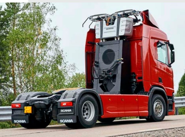
Die Scania R 450 mit Siemens-Pantograf sind Hybrid-Lkw – mit 13-Liter-Dieselmotor.
