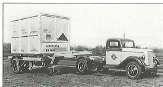
Der Daf-Losser mit Wechselbrückenbehälter für den kombinierten Verkehr.
