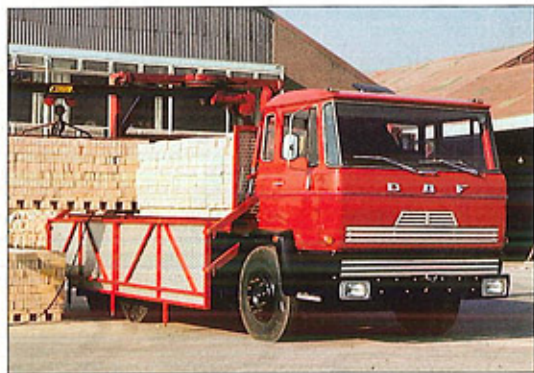
Die neue Baureihe 2000 von 1970 verfügte über ein Kippfahrerhaus.
