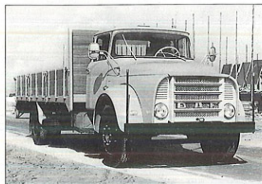
1964 kam die zweite Generation der Torpedo-Hauber mit bis zu 155 PS für 12,2 Tonnen.
