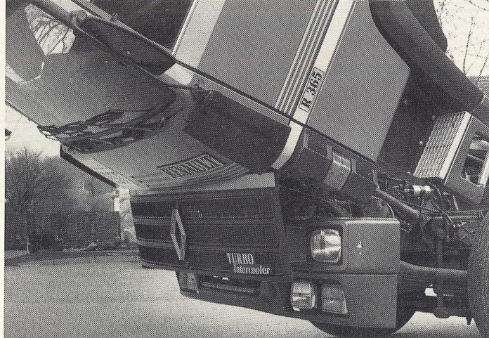
Das Fahrerhaus kann weit nach vorn gekippt werden
