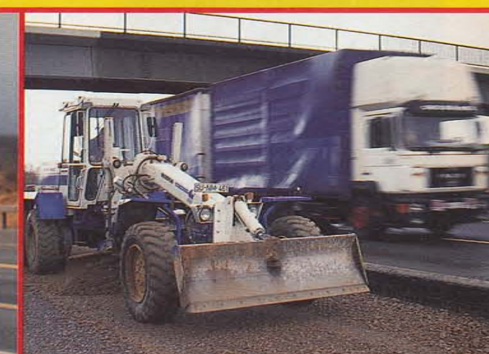
Maßarbeit: Der Grader fährt die Frostschutzschicht plan
